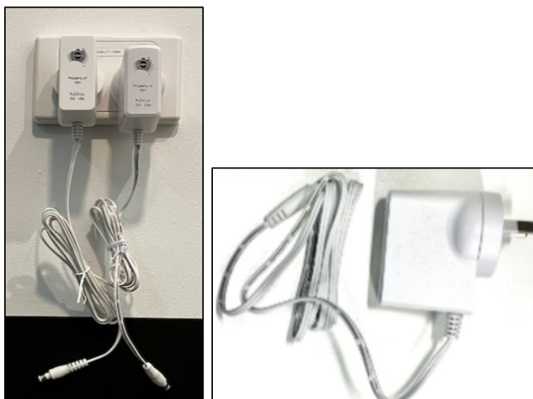
Figure 28. FTTP NTD 12V DC PSU
